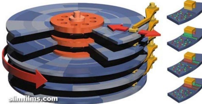
Questi dischi sono sempre in rotazione in modo da rendere più rapido l'accesso in lettura e scrittura. Le velocità di rotazione sono altissime e per questo motivo gli hard disk sono sigillati. Anche un granello di polvere potrebbe distruggerli. Sono dispositivi solitamente molto capienti (vedi slide comparativa).
